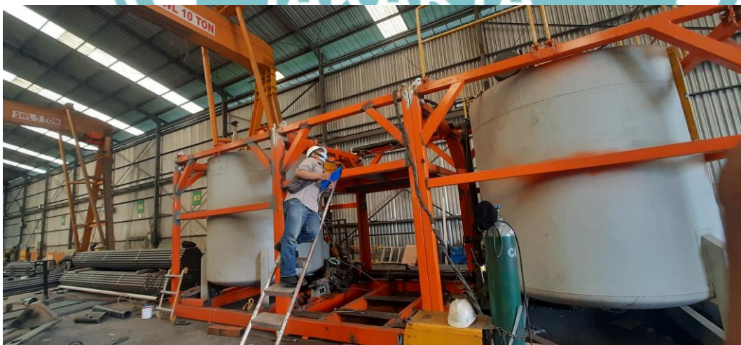
Inspeksi Hasil Pengelasan Tangki Bahan Minyak
