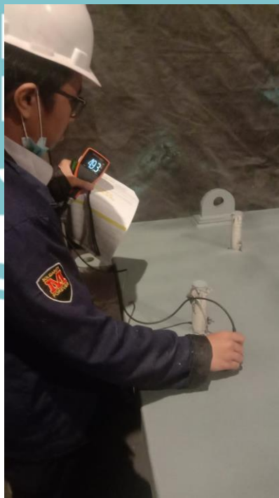
Mengukur Ketebalan Cat Menggunakan Elcometer
