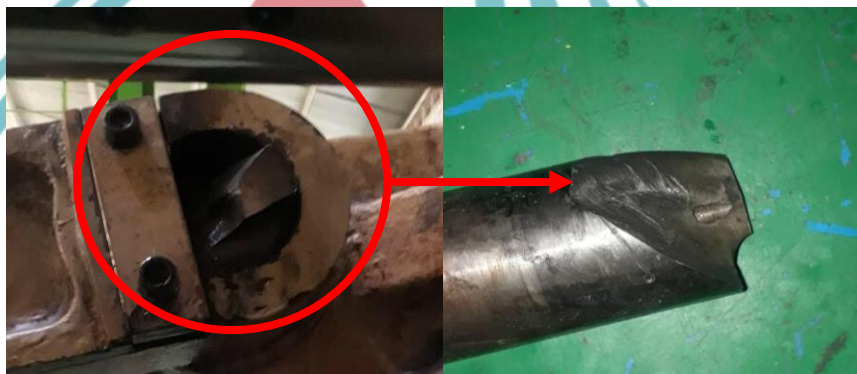
Gambar 4. 1 Kerusakan pin toggle clamping unit
