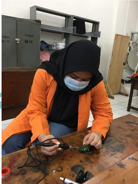
Menyolder Sistem Minimum
