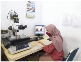
Pengukuran dimensi body keropos terkait dengan inlet pada input katup tabung baja.
