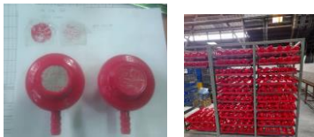
Inspeksi pewarnaan pada kualitas painting saat sortir regulator gas M-012 yang mengalami repair .
