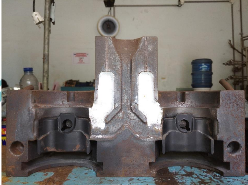
Gambar 24 Cetakan Luar Piston X sebelum Improvement
