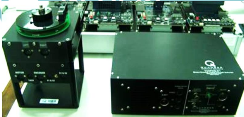
Gambar 1.3 Modul Latih Pemrograman Pendulum Berbasis Mikrokontroler dan FPGA
