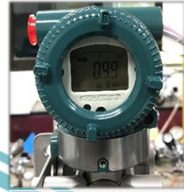
Tekanan setelah proses vakum (-0,99 atm)
