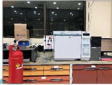
Analisis produk reference gas menggunakan GC.
