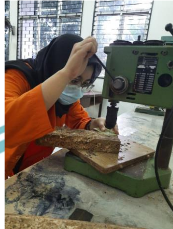
Saat melakukan pengeboran untuk melubangi PCB power supply
