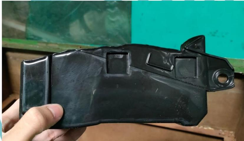
Gambar 3-3 Contoh Short mold atau Short shot Gambar
