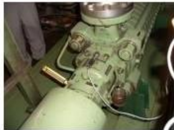
Gambar 6. Pengambilan data vibrasi arah axial pada NOx Water Pump GT 11
