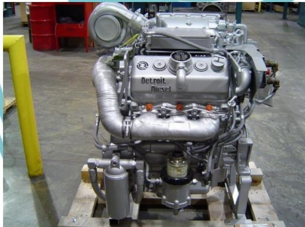
Gambar 2. 6 Mesin Diesel 2 Tak
