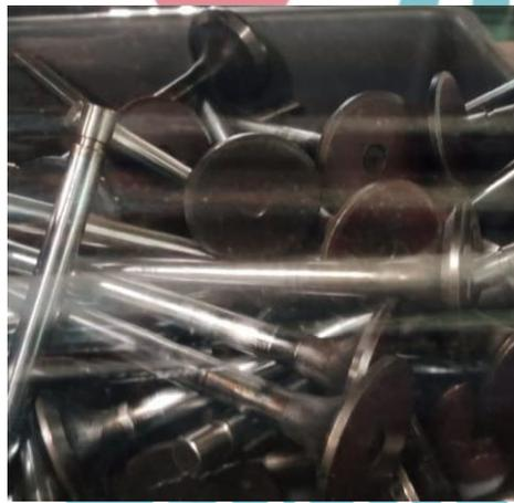
Gambar 2. 10 Valve Mesin Diesel
