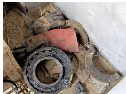
Gambar 2 Kerusakan pada bearing
