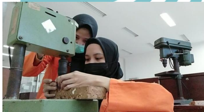
Proses Pengeboran PCB Untuk Catu Daya
