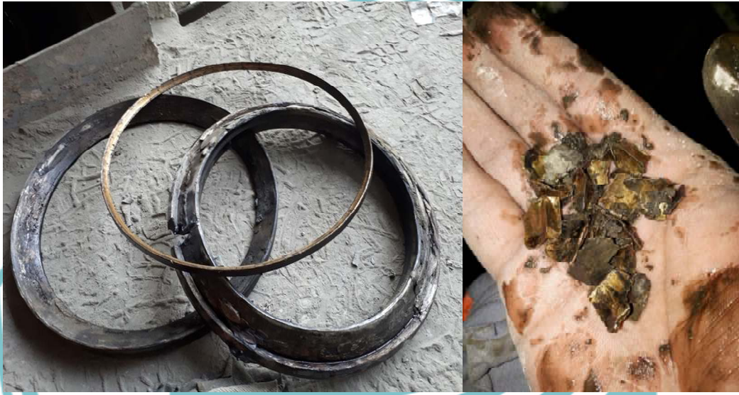
Gambar 1. 1. Foto bearing hancur saat proses maintenance dan temuan indikasi awal bahwa cage bearing telah hancur
