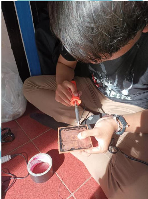
Menyolder PCB Shield
