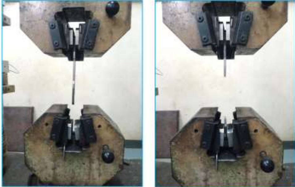
Gambar 23. Sample Chain Link Approne Conveyor Sebelum Uji Tarik dan Sesudah Uji Tarik
