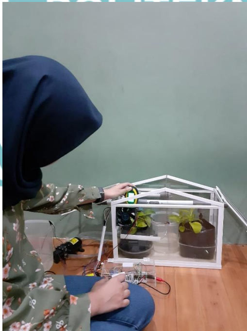
Lampiran 6. Proses Pengukuran Tingkat Kelembapan Tanah Menggunakan Alat Soil Analyzer.
