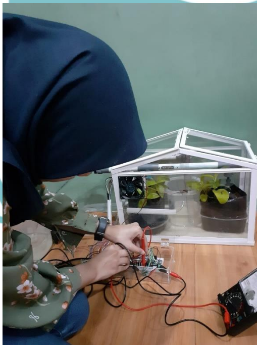
Lampiran 4. Proses Pengujian Rangkaian Catu Daya Pada Modul Step Down 5V.
