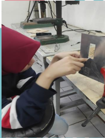
Proses Mengikir Plat Alumunium
