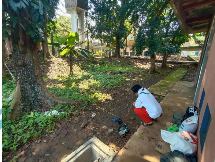
Gambar L. 7 Proses Pengambilan Data Nilai Tahanan Pembumian
