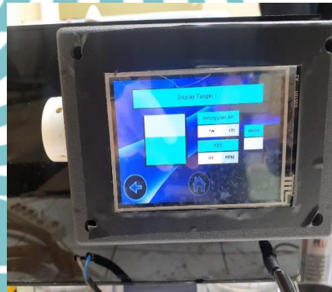
Gambar Lampiran 4. Tampilan HMI untuk Monitoring Kekeruhan dan Ketinggian Air Kolam Ikan Koi (Sumber : Dokumentasi Pribadi)
