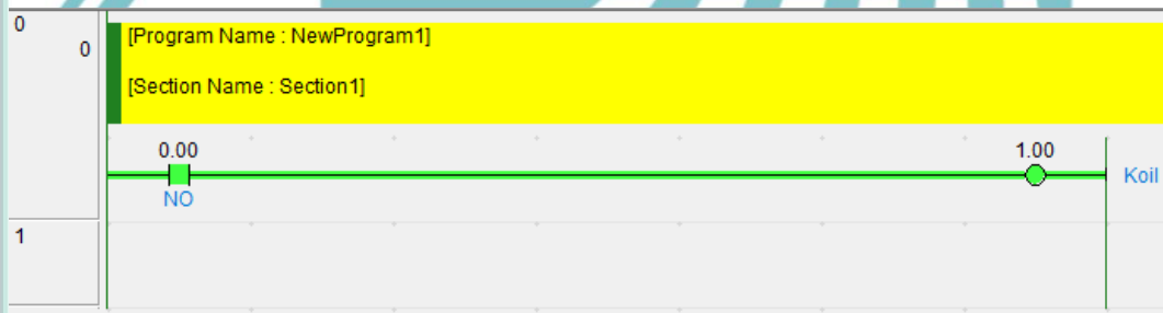
Gambar 1.1 (b) Saklar NO yang diberi logic 1
