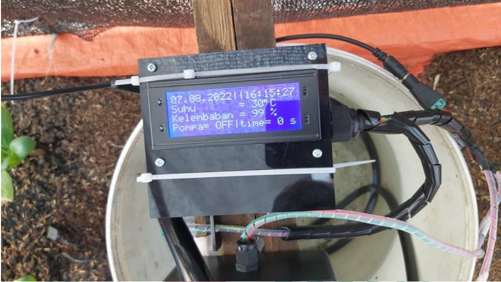
Gambar L-2 Box Panel 1 (TX)
