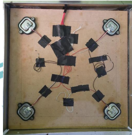
Gambar L-9. Posisi Sensor Loadcell
