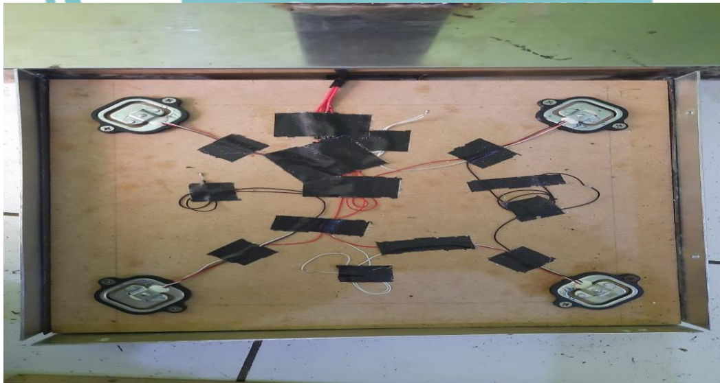
Gambar L- 4 Foto Instalasi Loadcell Pada Timbangan
