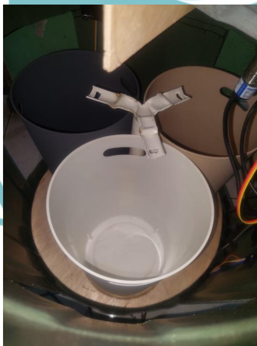
Gambar L.3 Tabung sampah organik, anorganik, dan logam yang ada didalam prototype
