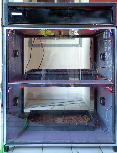
Alat Pengendali Suhu dan Kelembapan Tanah Bilik Tanaman Selada
