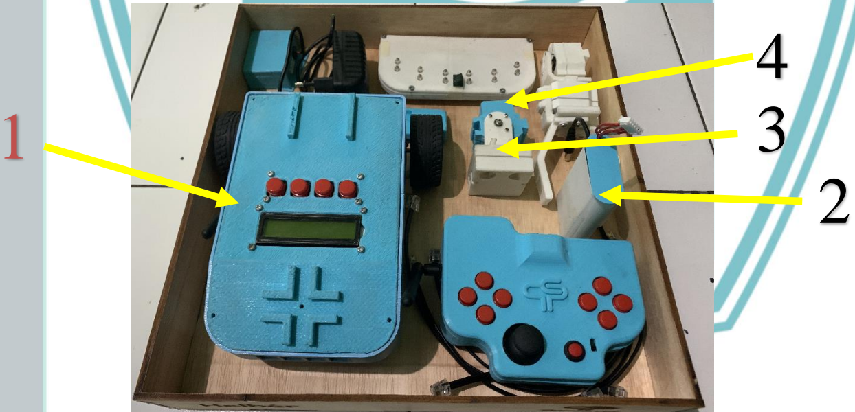
Gambar 1.4 komponen robot avoider
