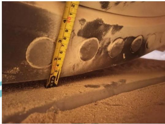
Setelah itu, posisikan roller raw mill pada posisi roller full up. Kemudian, catat kembali ketinggian roller dan jarak deteksi sensor terhadap metal target
