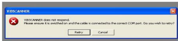
(d) Download ! . Ensure that Vibscanner is well connected with computer and vibscaner must be turned on. If connection is not good and Vibscaner is not turned on there will appear error messages. ( Download !, Pastikan bahwa Vibscaner terhubung dengan komputer dan Vibscaner harus di nyalakan. Jika koneksi dengan komoputer tidak bagus dan Vibscaner tidak dinyalakan makan akan muncul pesan error di layar computer )
