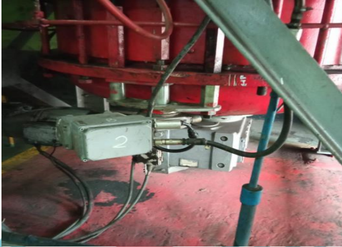
Gambar 1. 4 Letak motor autogap pfister feeder menempel di pfister feeder 482-PF1
