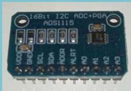
Gambar 2.2 Modul ADC ADS1115
