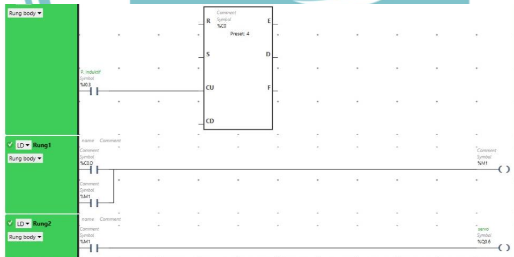
Gambar 3.1 Program Ladder PLC Untuk Mengaktifkan Servo
