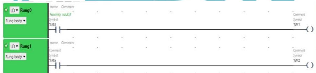
Gambar 2.1 Program Ladder PLC Untuk Mendeteksi Benda Logam dan Non Logam
