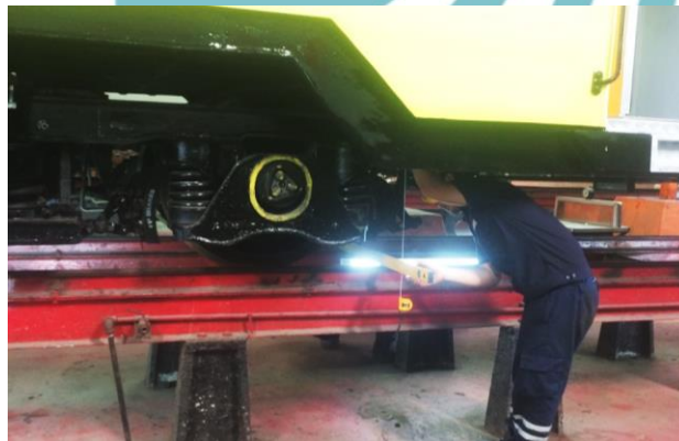
Gambar 1.2 Pengukuran Tinggi Bogie Secara Manual
