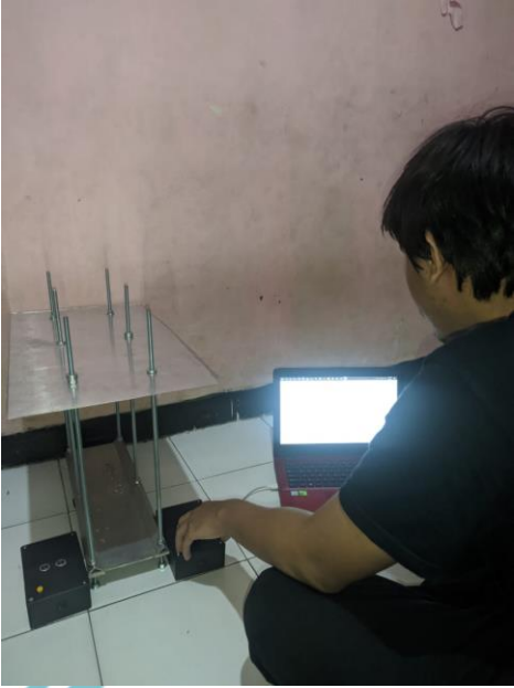
Gambar L-5 Pengujian Pengukuran Ketinggian Model Bogie Kereta
