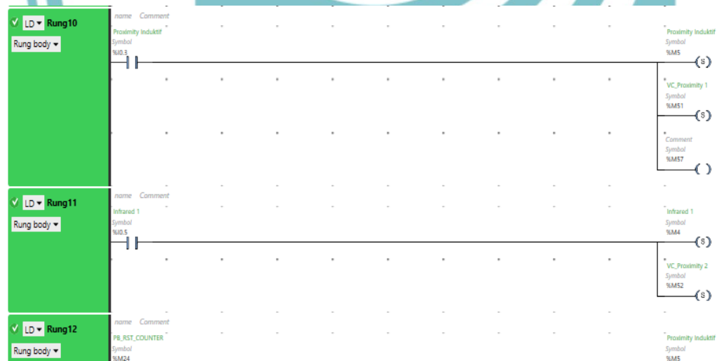
Gambar 2.1 Program Ladder PLC Untuk Mendeteksi Benda Logam dan Non Logam
