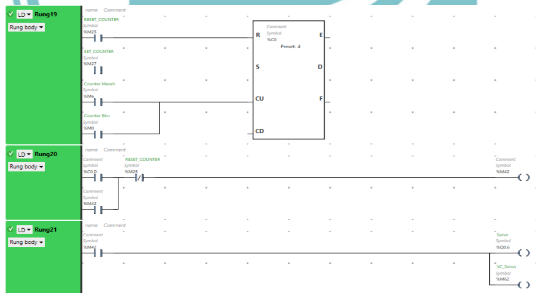
Gambar 3.1 Program Ladder PLC Untuk Mengaktifkan Servo
