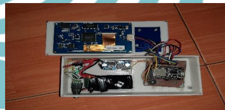
Gambar L.3 Tampak Dalam Box Integrasi RFID dan HMI
