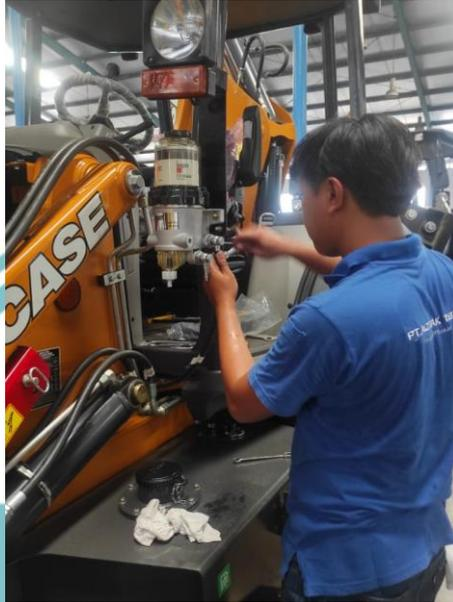
Gambar 3.23 Proses Pemasangan *hose* ke dalam lubang in *Fuel Pro* .
