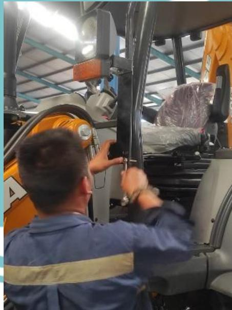
Gambar 3.20 Proses Pemasangan braket Pada Unit
