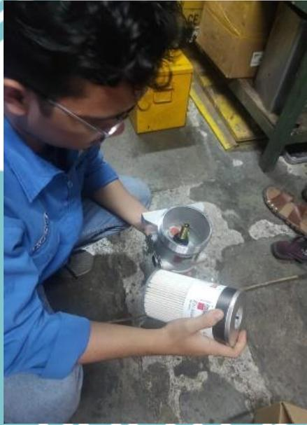
Gambar 3.15 Pemasangan *Element Filter* Ke *Diesel Fuel Pro*
