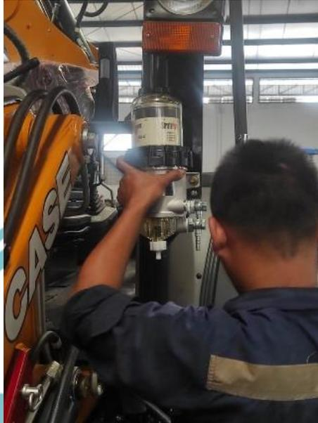
Gambar 3.21 Proses Pemasangan *Fuel Pro* Pada braket
