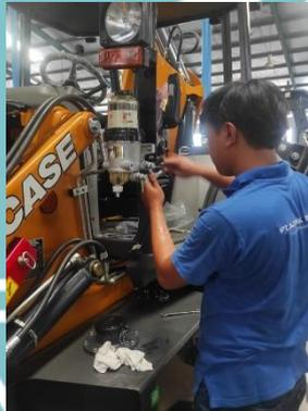
Gambar 3.13 Pemasangan *hose* ke lubang in *fuel pro*
