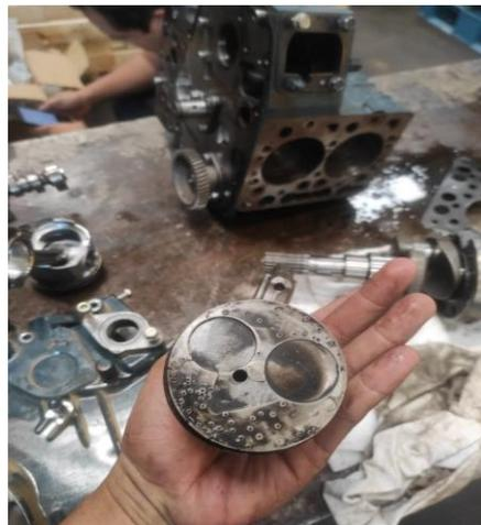
Gambar 3.32 Permukaan Piston Yang Cacat
