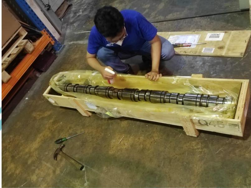
Gambar 3.37 Pemberian Pelumas pada Camshaft
