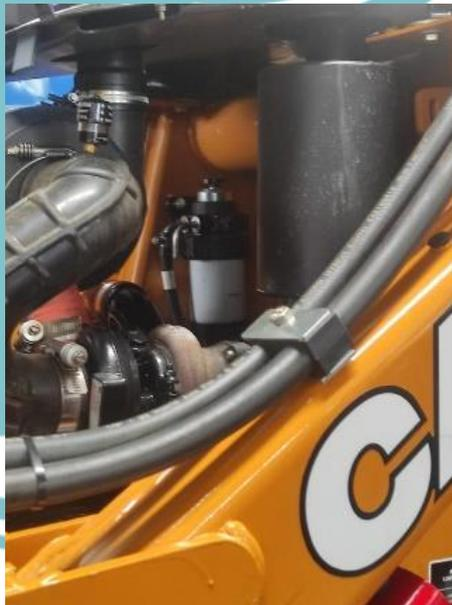
Gambar 3.22 Proses pelepasan *hose in* pada *Priming pump*
