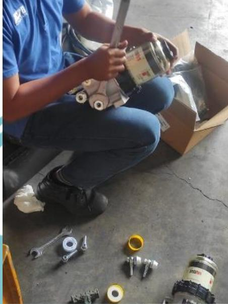
Gambar 3.17 Pemasangan *Konektor* Ke Lubang *In* Pada *Fuel Pro*
