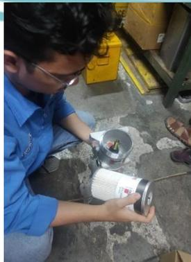
Gambar 3.7 Pemasangan *Element Filter* Kedalam *Diesel Pro*
