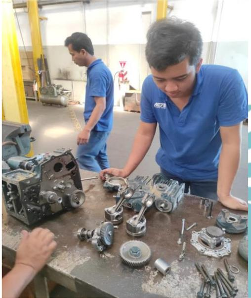
Gambar 3.30 Proses Pelepasan komponen
