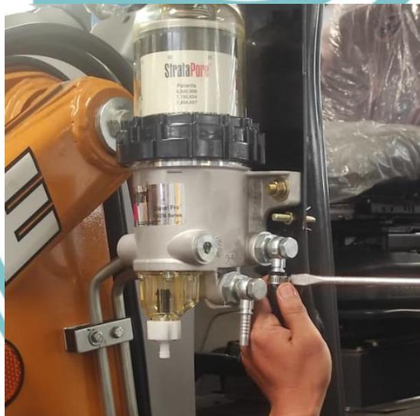
Gambar 3.24 Proses Pemasangan *hose* ke dalam lubang in *Fuel Pro* .
