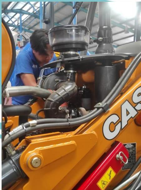
Gambar 3.26. Proses Pengencangan *Hose* ke *priming pump*.
