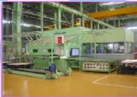
TWB I - WA Maker : OYABE SEIKI Capacity : 95,040 Pcs / Shift
