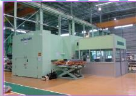
TWB II - WB Maker : OYABE SEIKI Capacity : 95,040 Pcs / Shift
