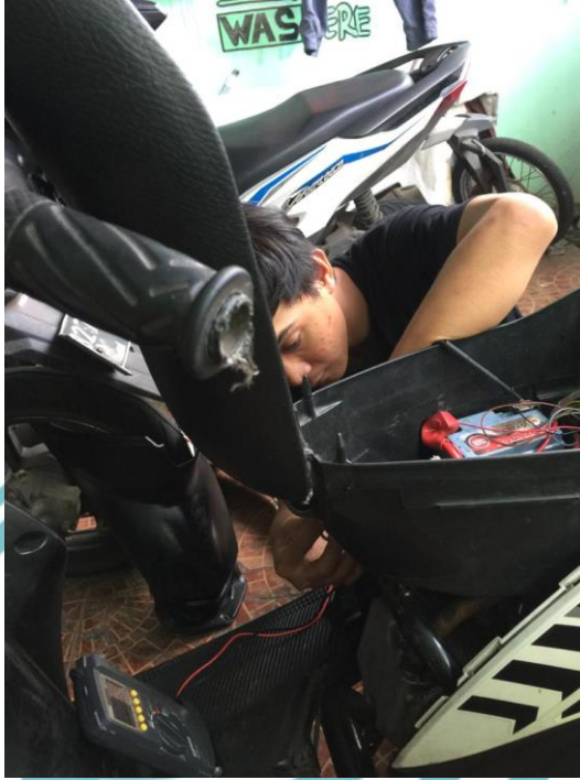
Pengecekan Tegangan pada Kabel dari Input Motor
