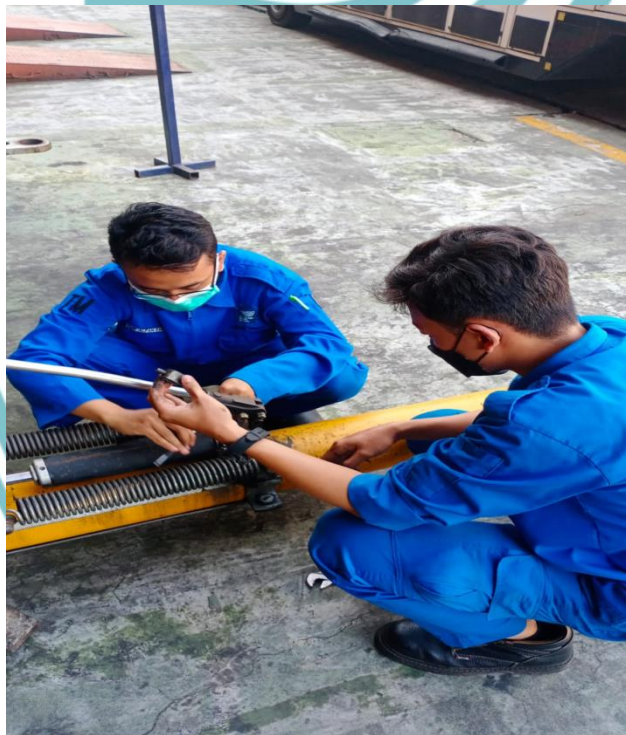
Gambar 4. Kegiatan saat mengganti Pump Towbar yang rusak
