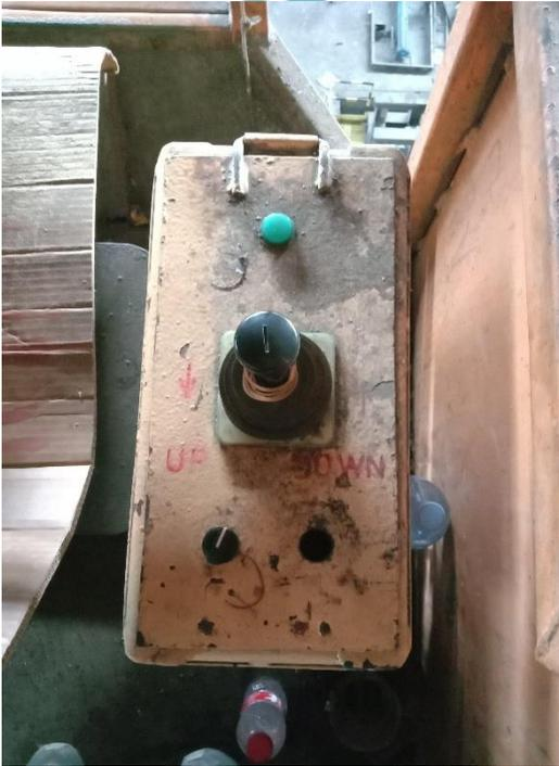
*Joystick sebagai pengontrol overhead crane*
