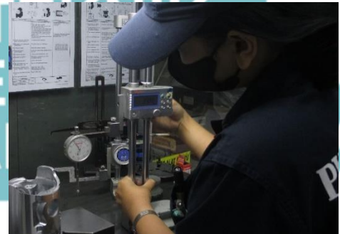
Inspeksi Incoming Piston dengan menggunakan Sungkeng
