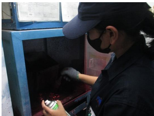
Melapisi Piston menggunakan penetran untuk pengecekan cacat piston dengan cara color check
