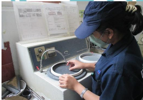
Menghaluskan permukaan potongan piston sebelum melihat struktur mikronya
