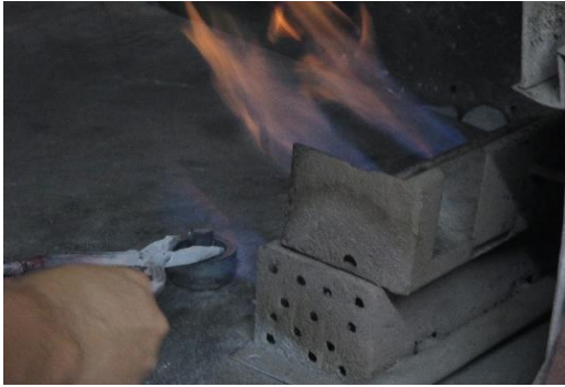
Piston di panaskan sebelum dilapisi developer untuk dilakukan scan menggunakan GOM
