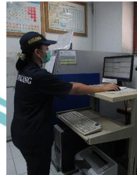
Mengecek komposisi material menggunakan mesin spectro
