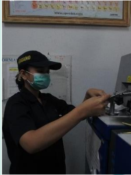
Mengecek komposisi material menggunakan mesin spectro
