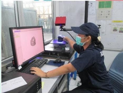
Scan piston menggunakan GOM
