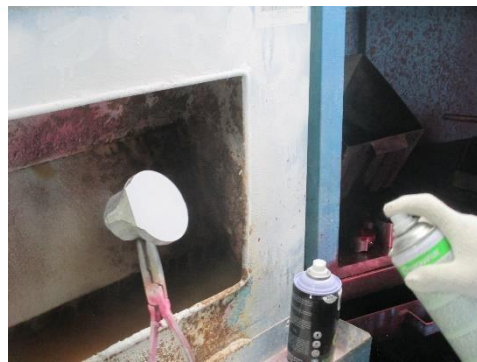
Melapisi Piston menggunakan developer setelah penetran untuk pengecekan cacat piston
