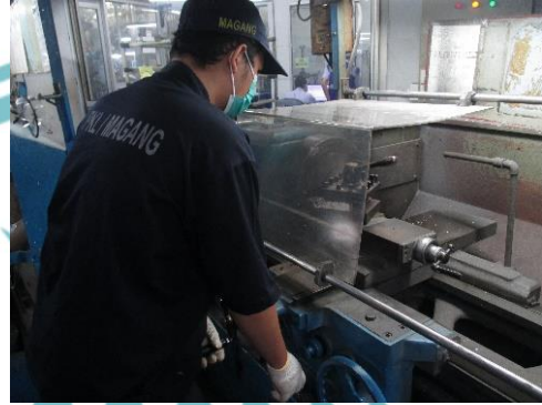
Membubut piston atau material untuk pengecekan color check, HRB, Spectro.
