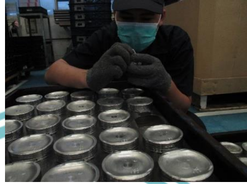
Melakukan Pengecekan Visual piston.
