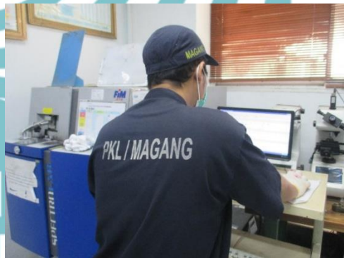
Mengecek komposisi material menggunakan mesin spectro
