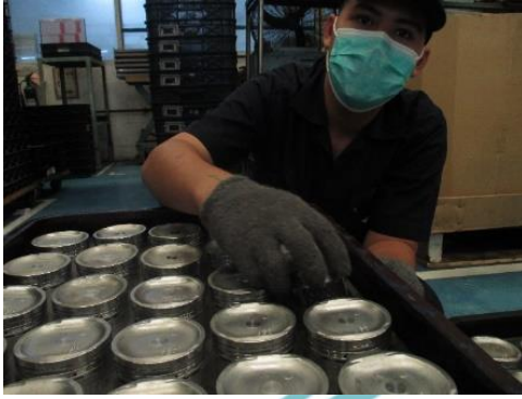
Melakukan Pengecekan Visual piston.
