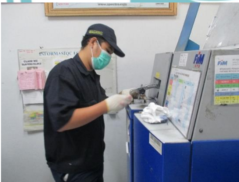
Mengecek komposisi material menggunakan mesin spectro
