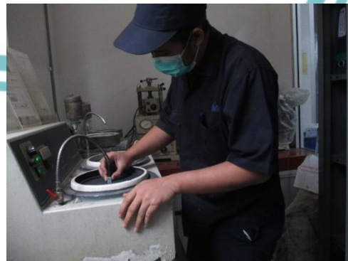
Melakukan Pengecekan macro dan micro menggunakan mesin polishing untuk melihat struktur silicon material.
