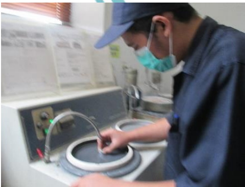
Melakukan Pengecekan macro dan micro menggunakan mesin polishing untuk melihat struktur silicon material.
