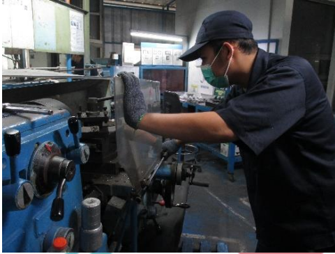
Membubut piston atau material untuk pengecekan color check, HRB, Spectro.
