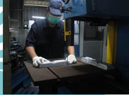
Melakukan Pemotongan Material menggunakan cutting machine manual dan membuat incoming ingot serta tuling.
