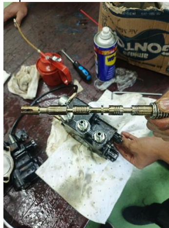
Gambar 5 Poros Control Valve Setelah Perbaikan
