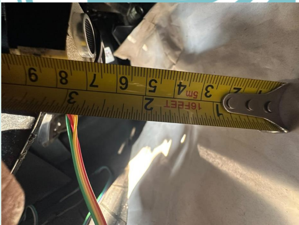
Lampiran 5 Pengukuran jara pedal rem mobil
