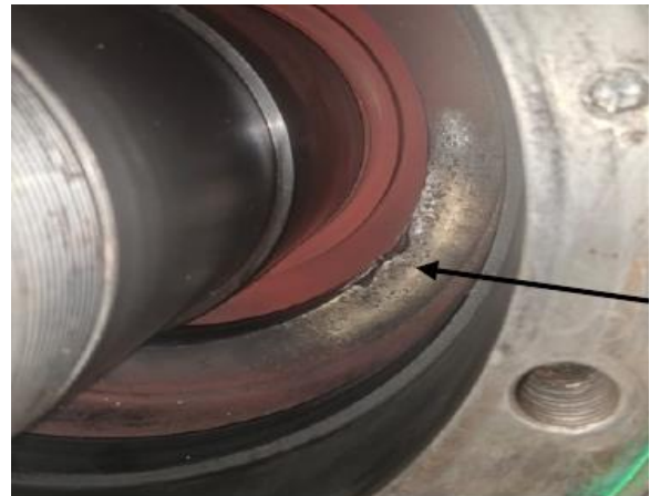
Gambar 4. Erosi pada pump discharge cover
