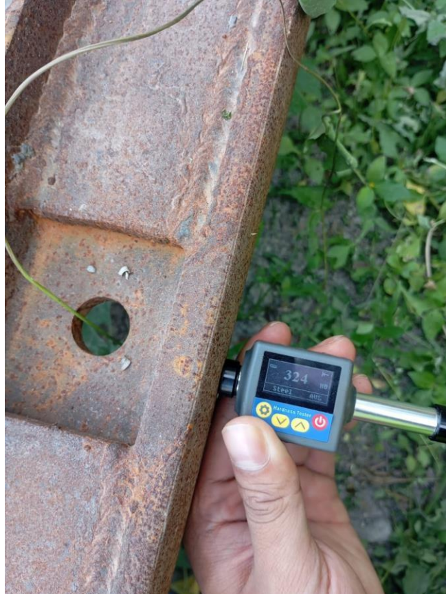
Gambar 5. Dokumentasi pengujian kekerasan pada zona sambungan las S900A-SS400
