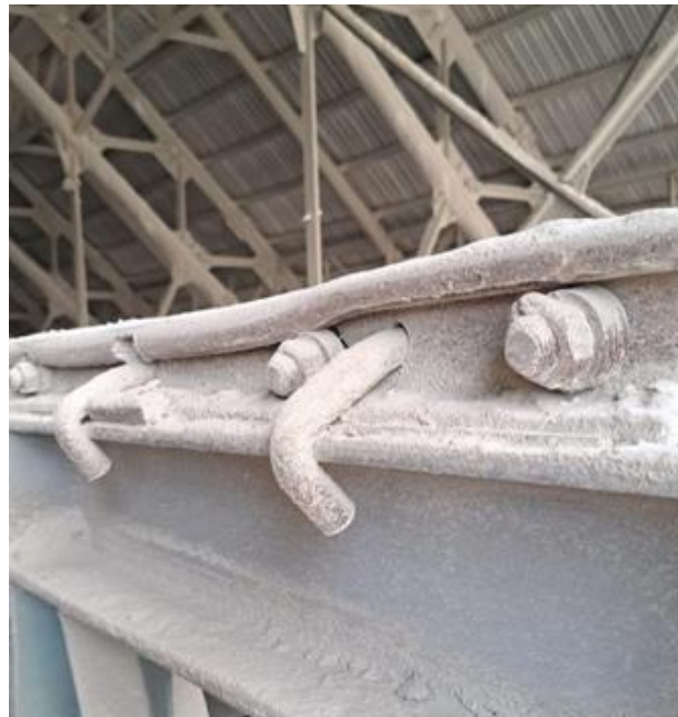
Gambar 2. Kondisi aktual rail Tripper 214-TR1 sebelum modifikasi
