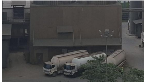
Gambar 1. 2 Proses inject material flyash dan CKD di bin T92-3B1 (Sumber: Dokumentasi Internal)
