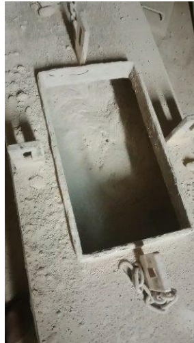
Gambar 3. Kondisi blocking dan penumpukan material yang menuntut pembersihan manual
