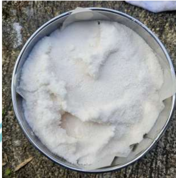
Lampiran 6. Padatan Hasil Reaksi Karbonasi Prototipe
