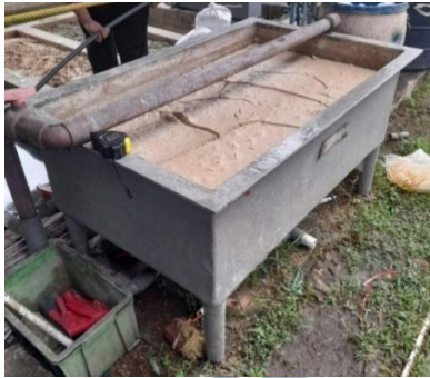
Gambar 1.2 Sludge Drying Bed PT X Sumber: Dokumen pribadi
